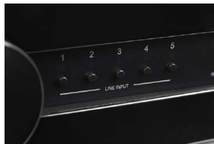
Regulacja prowadzona jest najbardziej klasycznym pokrętkiem z potencjometrem. Przełącznik źródeł jest już bardziej rozbudowany.
